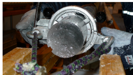
Bohrkopf mit Eiskern (Foto: Sepp Kipfstuhl; NEEM ice core drilling project, http://www.neem.ku.dk )
